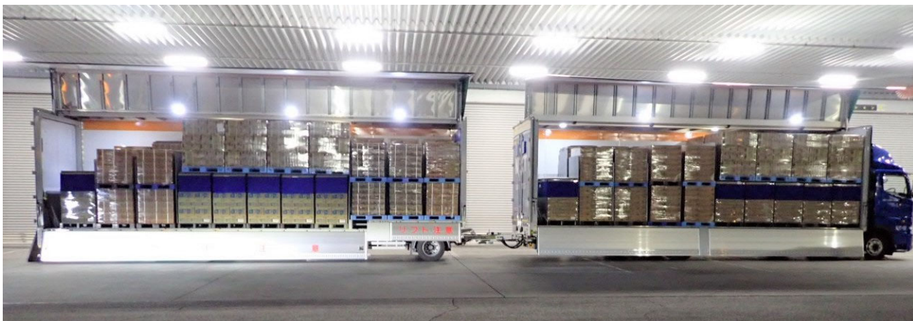
【写真:全高 4.1m ダブル連結トラック積付け 積載率 88% 達成 (2023 年 12 月 19 日)】
